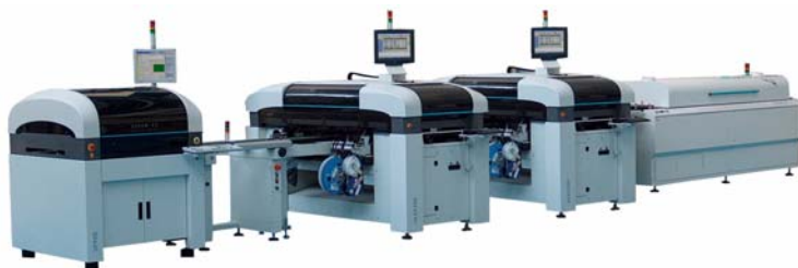
Megaflex-Bestückungslinie mit Inline-Drucker, HLX-Bestückungsautomaten und Vollkonvektions-Reflowofen (2006)
